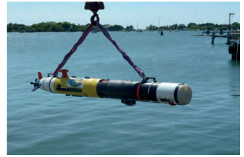
WBT Mini onboard the Remus AUV
